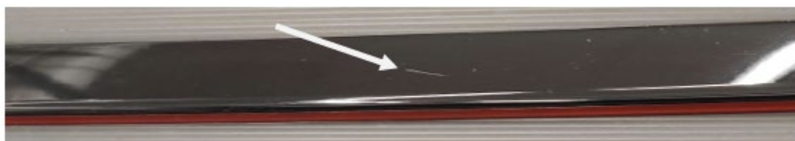
Obr. 2 Ryha na súčiastke (nezhodný výrobok) Fig. 2 Crease on the part (non-conforming product)
