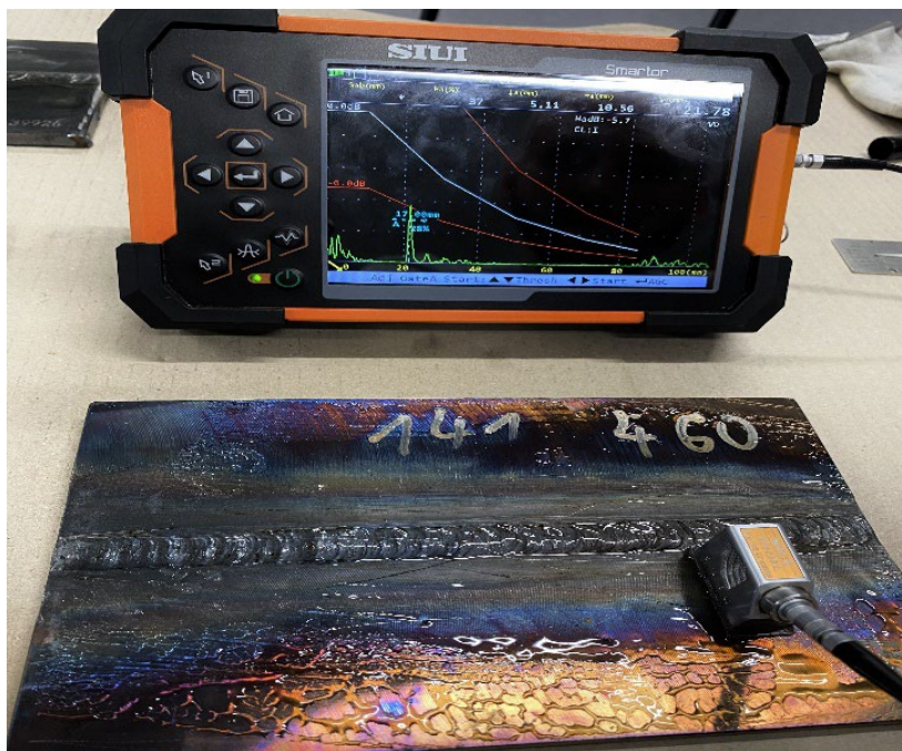
Obr. 4 Echo detegovanej chyby
