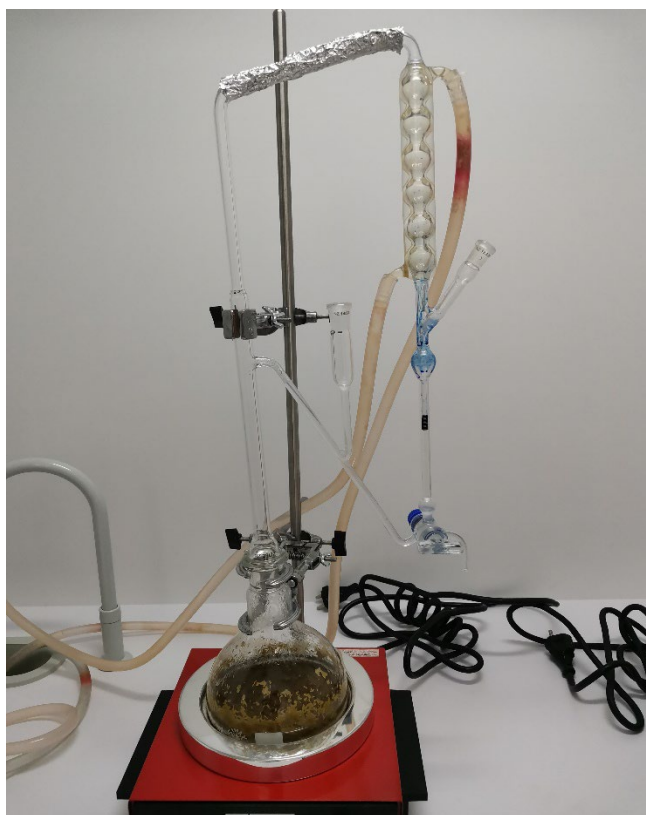
Obrázok 43 (vľavo) Destilačná aparátúra na získavanie silice rumančeka kamilkového – Matricariae aetheroleum
