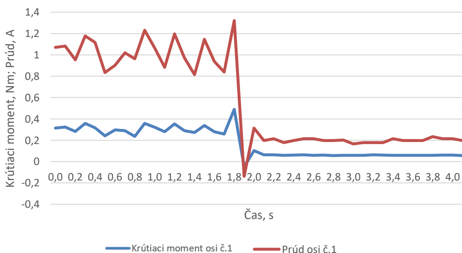
Obr. 9 Porovnanie krútiaceho momentu a prúdu osi č.1 pri rýchlosti 10 stupňov za sekundu Fig. 9 Comparison of torque and current of axis #1 at a speed of 10 degrees per second
