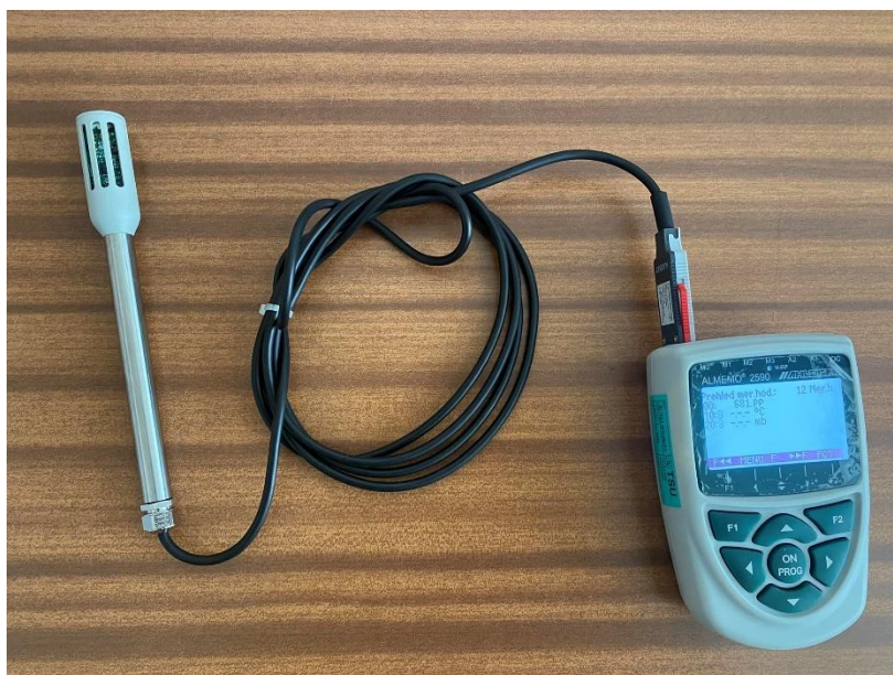
Obr. 3 Sonda na meranie koncentrácie CO 2 Fig. 3 CO 2 concentration measuring probe CO 2
