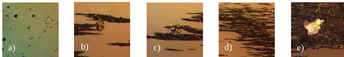
Obr. 5 Snímky častíc v hydraulической kvapaline pri: a) 0 Mth, b) 200 Mth, c) 400 Mth, d) 600 Mth, e) 860 Mth
