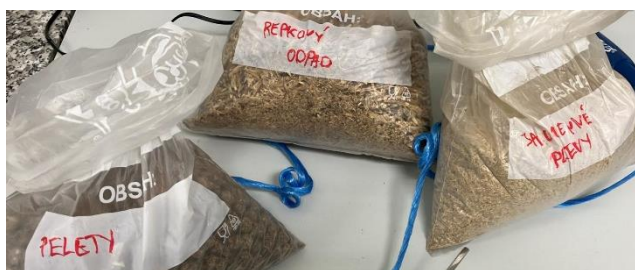
Obr. 6 Z ľavej strany: EO Tmavá peletka, vedľajší produkt žatvy repky, jačmenné plevy (obe zložky peliet) (Zdroj: autorka) Fig. 6 From the left side: EO Dark pellet, by-product of rape harvest, barley chaff (both pellet components) (Source: author)
