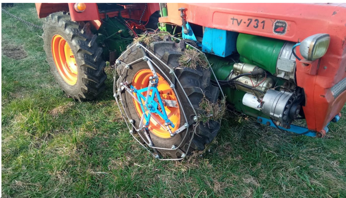
Obr. 1 Experimentálny traktor TV 731 so špeciálnymi hnacími kolesami v aktívnej polohe hrotov na prednej náprave
