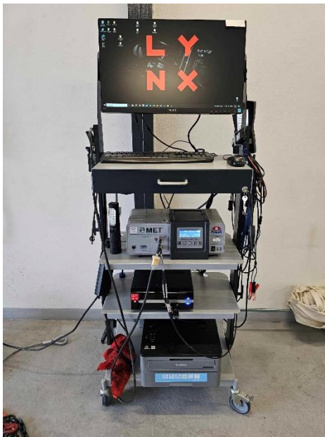
Obr.5: Analyzátor výfukových plynov MAHA MGT 6.3 [Vlastná fotografia]
