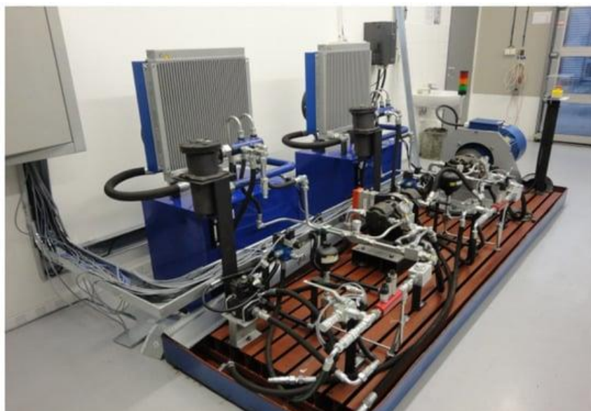
Obr. 1 Súbežné testovacie zariadenie hydrostatických prevodníkov (KDM TF, Tkáč a kol. 2016, Hujo a kol. 2017)
