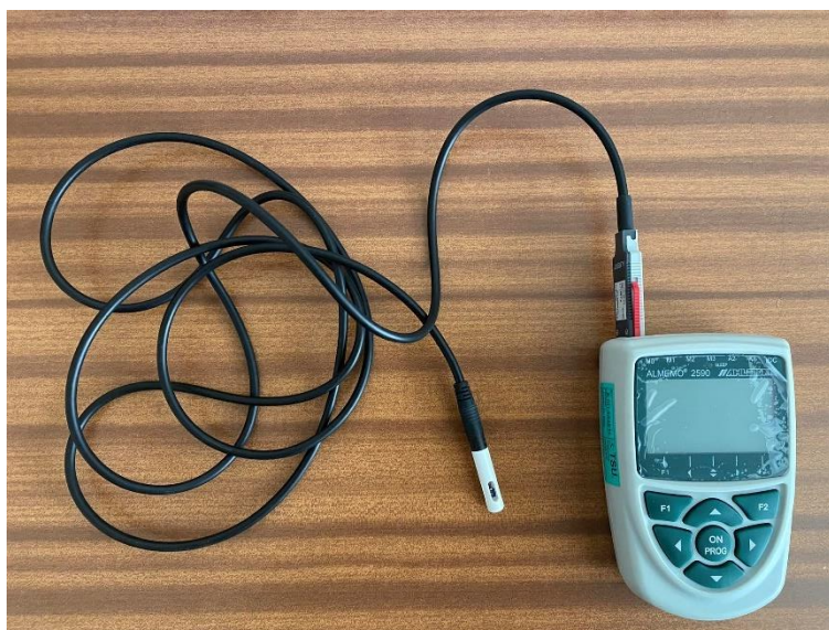
Obr. 4 Sonda na meranie teploty, vlhkosti a atmosférického tlaku ALMEMO FHAD 46-C2 Fig. 4 Probe for measuring temperature, humidity, and atmospheric pressure ALMEMO FHAD 46-C2
