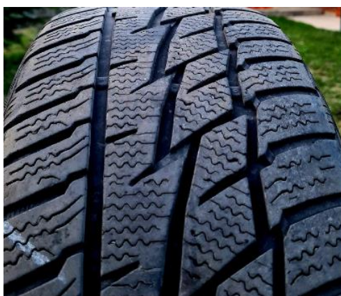
Obr. 4 Dezén zimnej pneumatiky Matador Sibir Snow Fig. 4 Tread of the winter tyre Matador Sibir Snow
