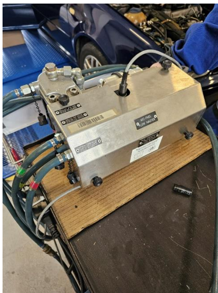
Obr.4: Prietokomer AIC-5004 Fuel Flowmaster [Vlastná fotografia]
