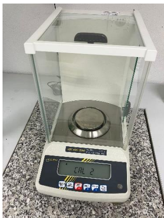
Obr. 4 Analytické laboratórne váhy KERN ABT 220-5DM (Zdroj: autorka) Fig. 4 Analytical laboratory scale KERN ABT 220-5DM (Source: author)
