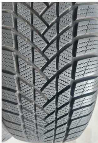
Obr. 2 Dezén zimnej pneumatiky Matador MP93 Nordicca Fig. 2 Tread of the winter tyre Matador MP93 Nordicca
