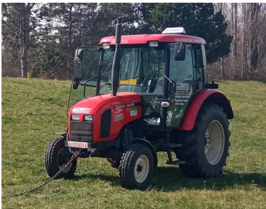
Obr. 2 Brzdiaci traktor Zetor 6321 Braking tractor Zetor 6321
