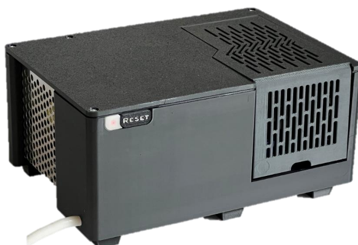
Obr. 6 Kryt zariadenia na meranie elektrochemických vlastností lítiových článkov Fig. 6 Casing of device for measuring electrochemical properties of lithium cells
