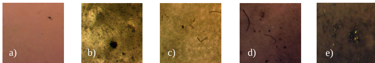
Obr. 4 Snímky znečistenia hydraulической kvapaliny pri: a) 0 Mth, b) 200 Mth, c) 400 Mth, d) 600 Mth, e) 860 Mth
