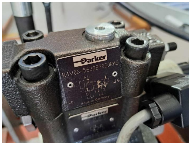
Obr. 3 EHPV elektrohydraulický proporcionálny tlakový ventil PARKER R4V EHPV electrohydraulic proportional pressure valve PARKER R4V
