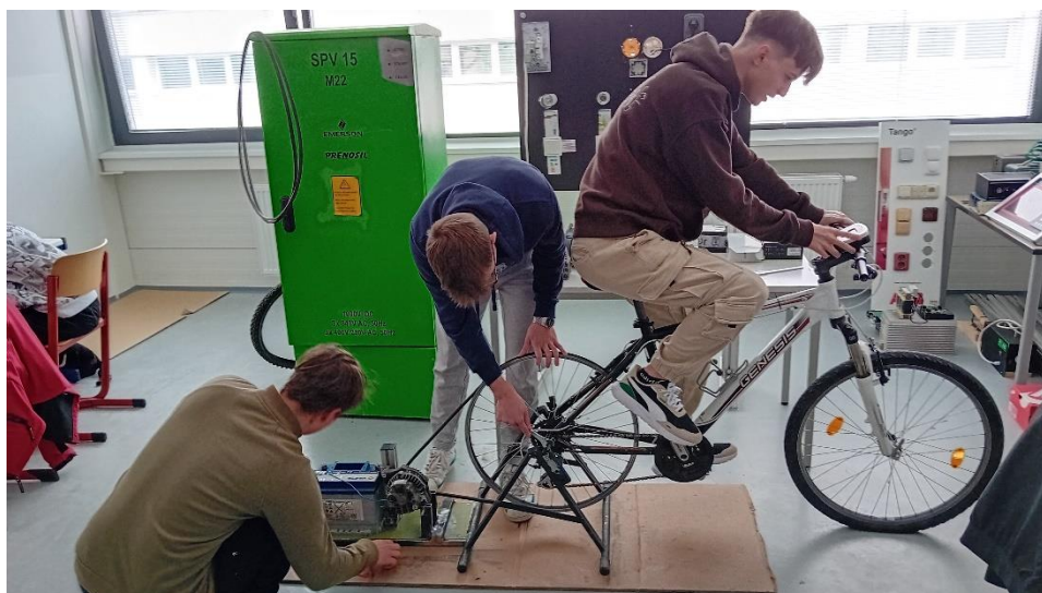
Obr. 3 Výroba elektrickej energie na nabíjanie elektrických zariadení pomocou bicykla a alternátora Fig. 3 Production of electricity to charge electrical devices using a bicycle and an alternator
