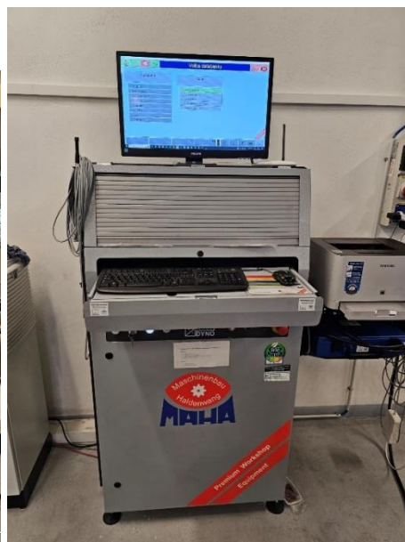
Obr.3: Valcová skúšobňa MAHA MSR 500 a komunikačný pult MCD 2000 [Vlastná fotografia]
