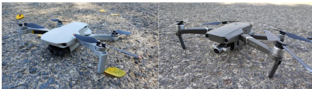
Obr. 2 Používané bezpilotné lietadlá – DJI Mini 2 (vľavo), DJI Mavic 2 Zoom (vpravo). Utilized unmanned aerial vehicles - DJI Mini 2 (left), DJI Mavic 2 Zoom (right).
