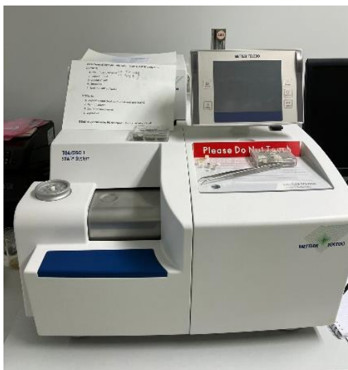
Obr. 1 Termogravimetrický analyzátor TGA/DSC 1 Mettler Toledo (Zdroj: autorka)
