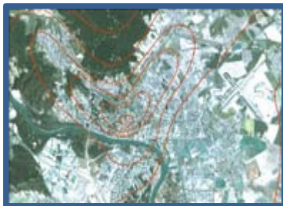
Obrázok 27 Umelé magnetické poruchy spôsobené elektrickou dopravou
