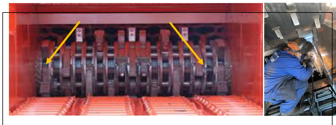
Figure 13 Poloha navárania závaží na kotúče bubna
