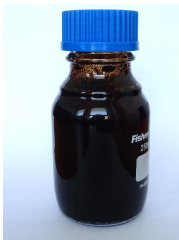
Obrázok 5 Výstupná tekutá zložka – reaktorový olej (400 °C)
