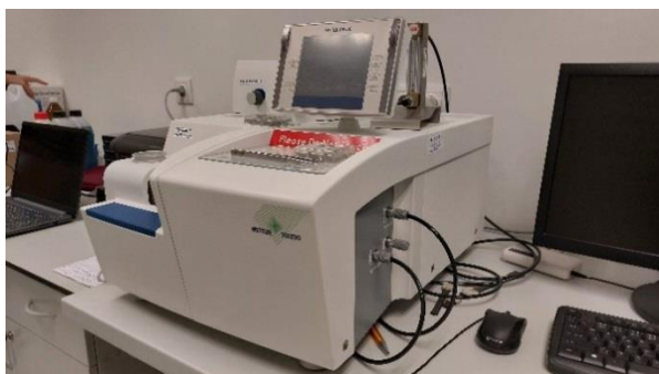
Obrázok 3 Kalorimeter TGA/ DSC 1, Mettler Toledo, Váhy s presnosťou 0,1 mg ABT Kern
