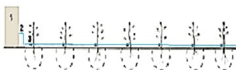
Obr. 2.2 Povrchová kvapková závlaha; 1 – filtračné zariadenie, 2 – prírodné potrubie, 3 – kvapkovače
