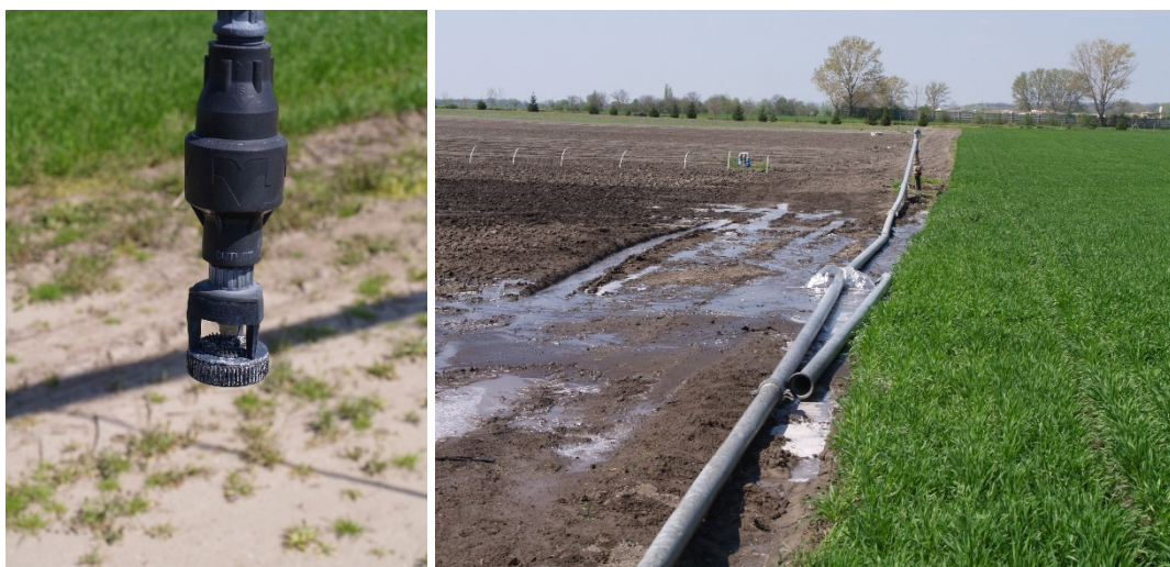
Obr. 2.4 Postrekovač (vľavo) a prenosné potrubie s hydrantom (vpravo) (Foto: Jurík)
