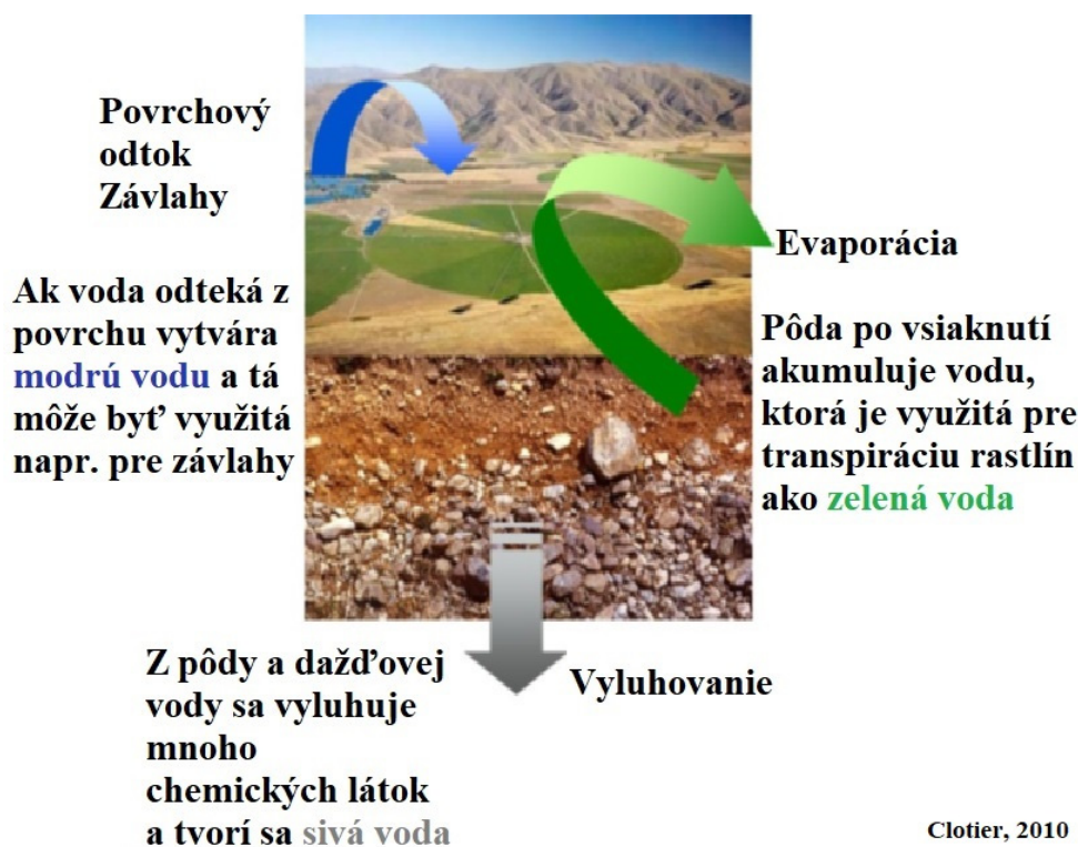
Obr. 1.3 Tri farby vody: zelená voda je evapotranspiračná dažďová voda z pôdy, modrá voda používaná na zavlažovanie a šedá voda kontaminovaná agrochemikáliami (Clotier et al., 2010)
