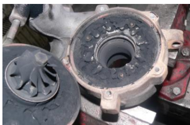
Obr. 3 Znečistenie turbodúchadla Fig. 3 Contamination of the turbocharger
