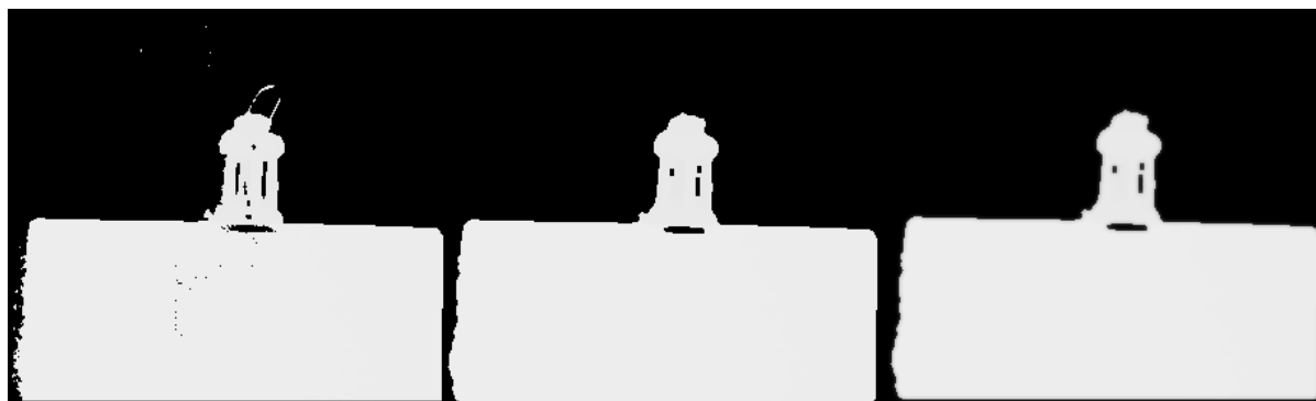
Obr. 3 Proces filtrácie obrazu mediánovým a bilaterálnym filtrom Fig. 3 Filtration process using median and bilateral filters
