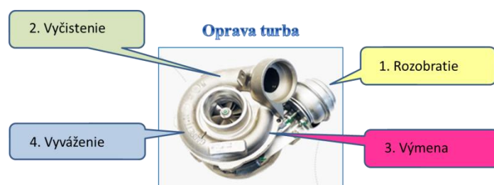
Obr. 2 Bloková schéma opravy turba
