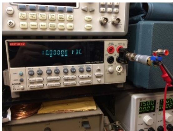
Obr. 8 Prvý test obvodu REF102 Fig. 8 First test of REF102 circuit
