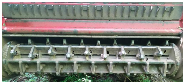
Obrázok 2 Valec - rotor adaptéra so založenými nástrojmi
