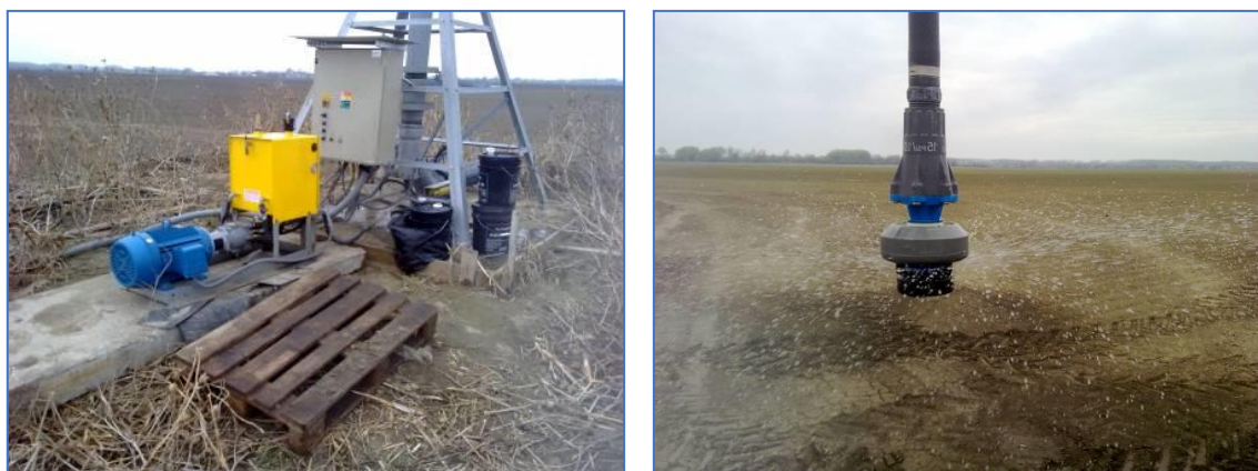
Obrázok 4 Pohonná jednotka a rozstrekovač na skúmanom zavlažovači
