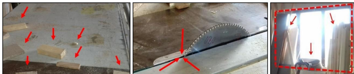
Obrázok 3 Pracovný stôl stroja s odpadovým materiálom, miesto chýbajúceho rozovierajúceho klina, materiál v mieste okien
